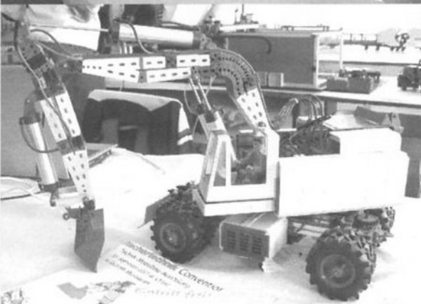
Michael Orlik: Graafmachine met zelf gemaakte pneumatische cilinders (links).
